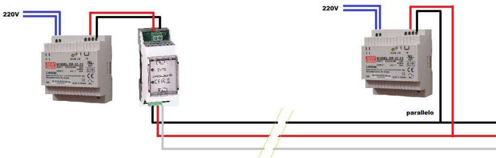
Gli alimentatori forniti da Evolus sono parallelabili, possono essere inseriti in qualsiasi parte del circuito rispettando solamente la polarità. Questo è parecchio
